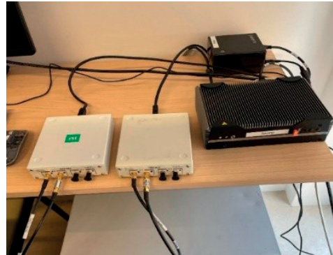
Figure 5 : Plateforme avec liaison radio sur câble (Crédit photo : Philippe Martins).
