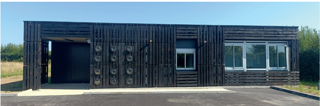
Figure 3 : Recyclerie de Montivilliers (76) – Archipel Zéro et PERMaC – composée de bardage en palettes de bois brûlé et hublots de lave-linge (Source : Frédéric Denise).
