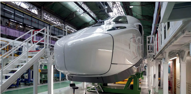
Figure 2 : Le carénage de TGV composite (Source : Groupe SNCF).
