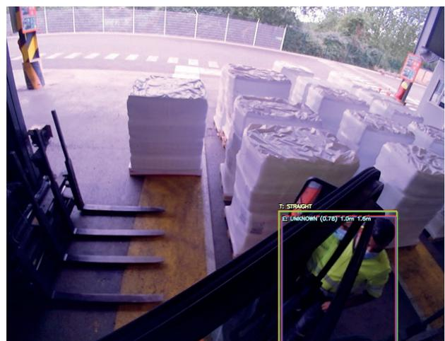
Figure 4 : Un exemple de la variété des images à intégrer dans une base de données en milieu industriel : posture inclinée ou droite, occultation, couleur de casque ou de gilet figurent parmi les nombreux paramètres à prendre en compte pour la détection de piétons (Source : Arcure - Blaxtair).
