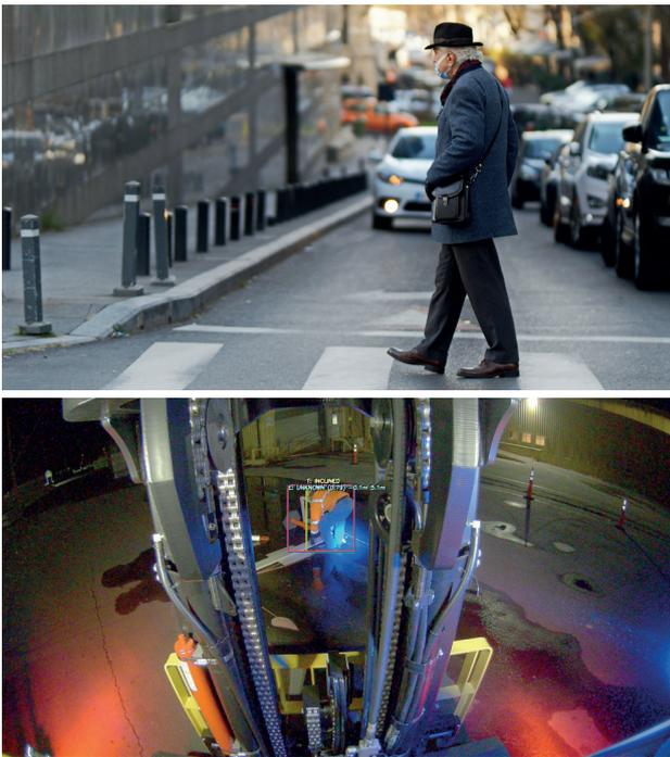
Figure 3 : L'identification de piétons sur des images captées sur la route et en milieu industriel ; alors que les images en milieu routier sont lisibles et standardisées, les images en milieu industriel sont bien plus complexes et d'une variabilité bien plus élevée (Source : Arcure - Blaxtair).
