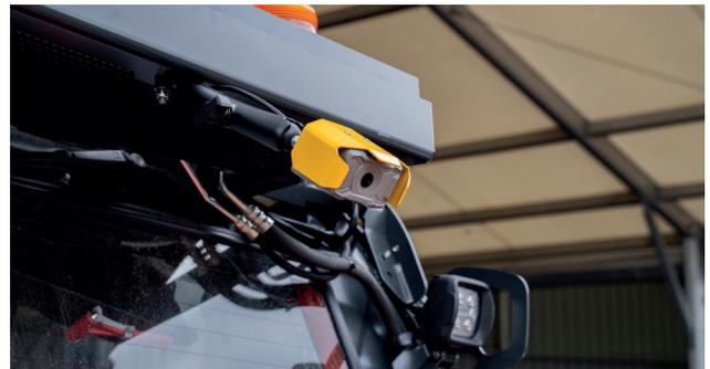
Figure 2 : Blaxtair®, première technologie d'IA au monde développée pour la sécurité des véhicules en milieu industriel ; ici, la dernière génération
