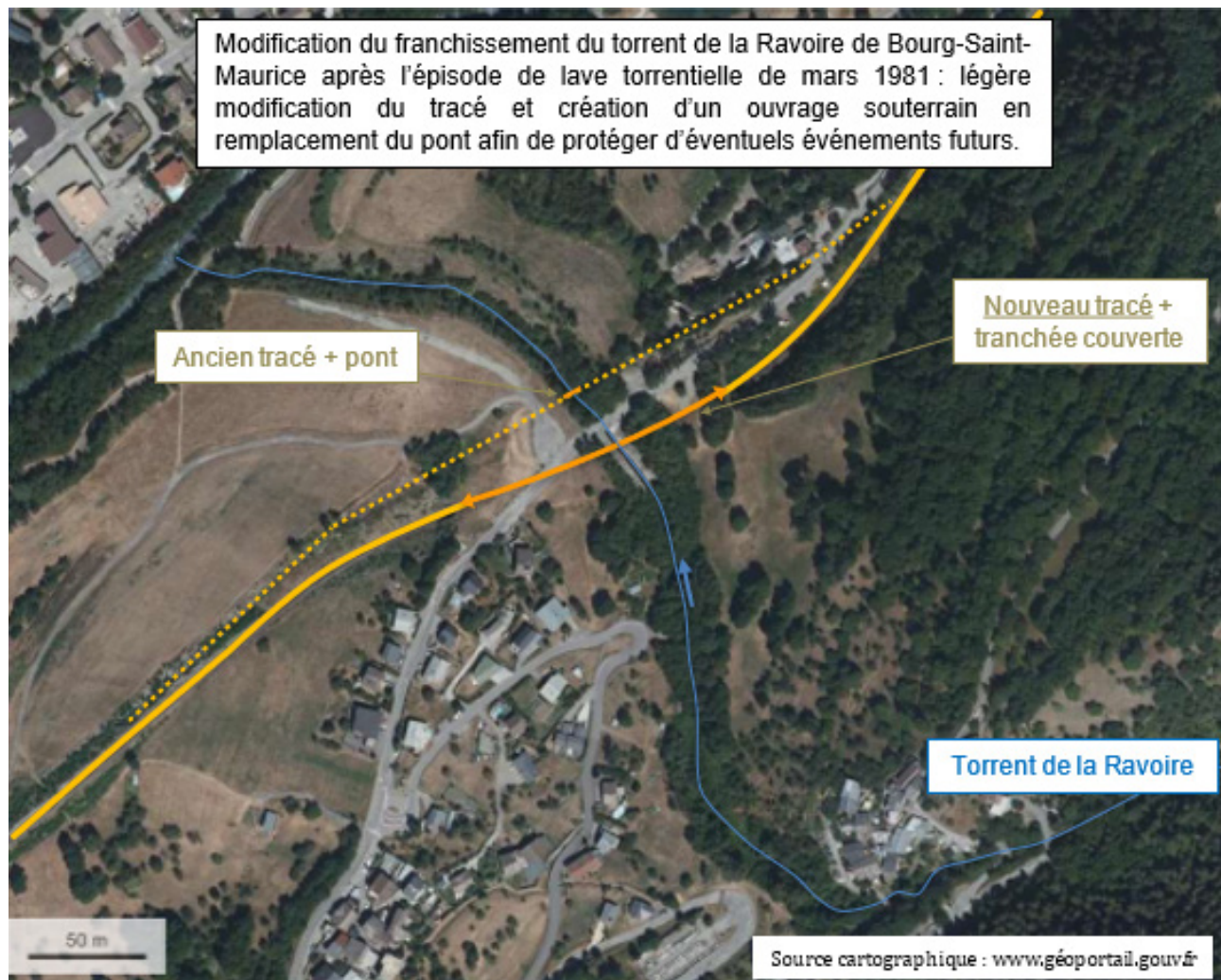
Figure 1 : Solution alternative retenue avec un changement de tracé plutôt qu'une réparation à l'identique : franchissement de la Ravoire de Bourg-Saint-Maurice (Source cartographique : www.geoportail.gouv.fr ).
