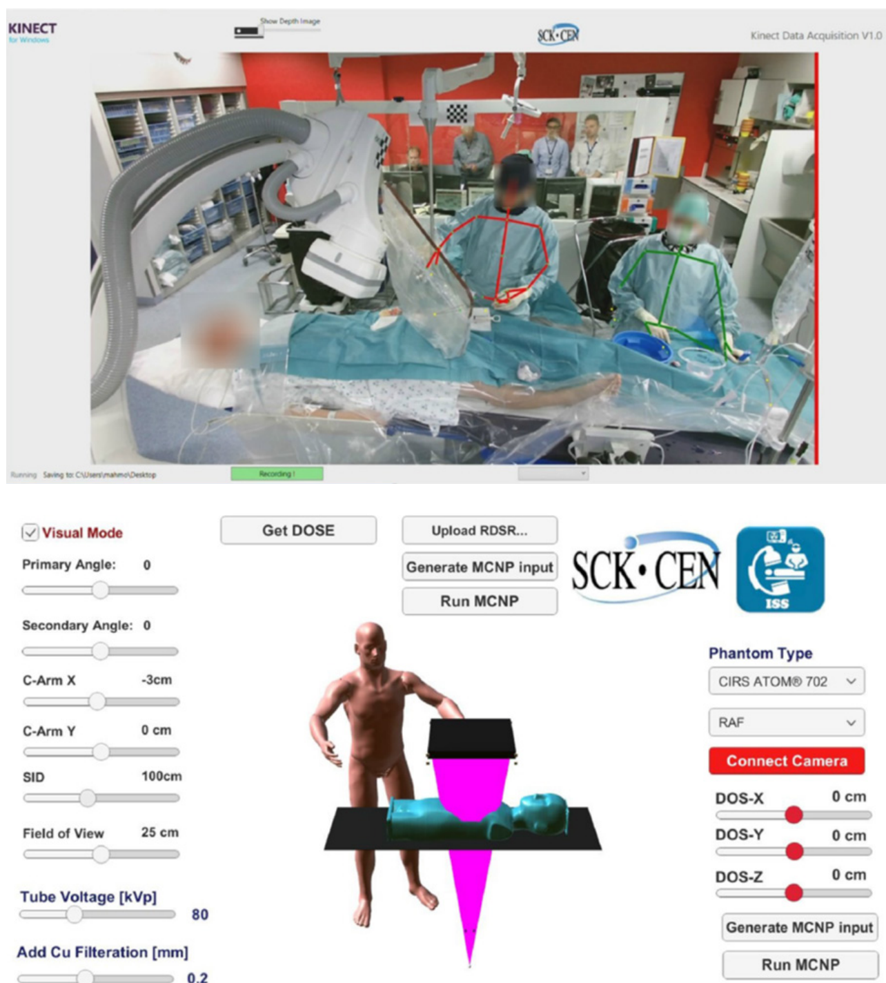
Figure 3 : Suivi de la silhouette des travailleurs pendant une procédure de radiologie interventionnelle (en haut) et logiciel permettant de générer les simulations de transport de rayonnement de Monte Carlo correspondantes, y compris la source de rayonnement et la géométrie d'exposition avec un fantôme anthropomorphe représentant le travailleur (en bas). Les figures ont été reproduites avec l'autorisation des auteurs (Source : Abdelrahman et al. , 2020).
